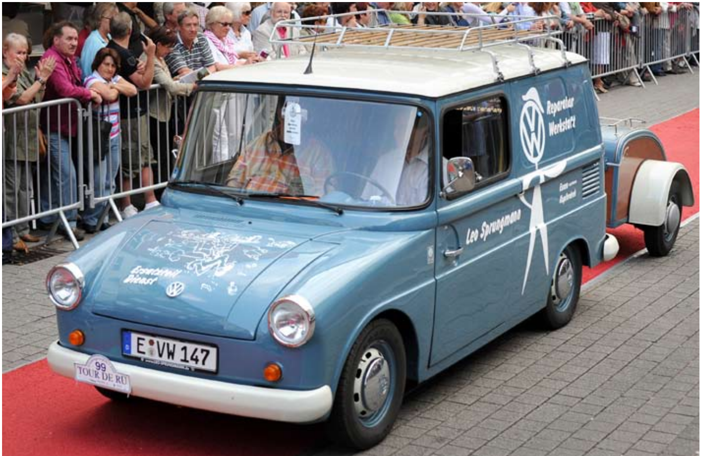
VW Typ 147 Fridolin, Bj. 1965, 4 Zyl., 34 PS, 1184 ccm mit Heinrich Sprungmann und Uwe Bürger. Das Modell war eine Co-Produktion des Posttechnischen Zentralamtes, der Westfalia Werke und der VW AG. Eingesetzt wurde der Kleinlieferwagen hauptsächlich bei der Deutschen Post. Aber auch die schweizerische Post, Lesezirkel und Privatfirmen nutzten dieses praktische Auto. Es wurden 6.125 Fridolins gebaut.
