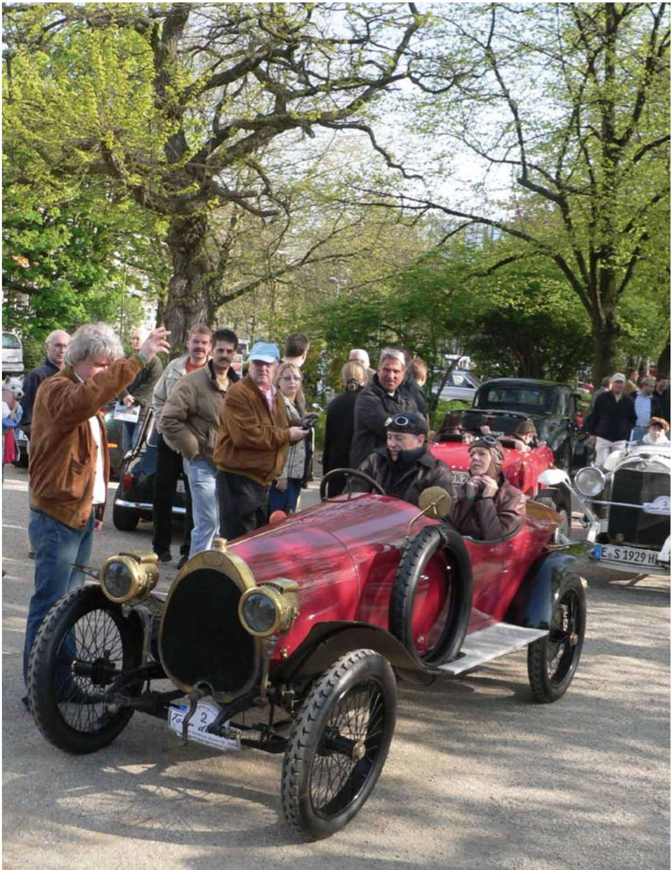
Am Start der Tour de Rü 2005: Das älteste Fahrzeug, das je mitgefahren ist. Ein Bugatti T15 von 1913 mit 18 PS, 4 Zylindern und 1400 ccm Hubraum. Am Steuer Dr. Joachim Jantzen, jahrelanger Präsident des Deutschen Bugatti-Clubs und Ehefrau Brigitte. Das Fahrzeug wurde 1913 nach New York geliefert, dort mit einer Karosserie versehen und bis 1925 gefahren. Danach wurde es zerlegt und von 3 Besitzern bis 1995 aufbewahrt. Ab 1995 erfolgt eine 8-jährige Restaurierung. Am 06.01.2005 wurde der Wagen wieder in Deutschland zugelassen. Der Bugatti Typ 13-17 ist der erste von Ettore Bugatti konstruierte und gebaute Wagen. Den Prototyp T10 baute er in Köln-Deutz, bei der Fa. Deutz. Es wurden etwa 105 Fahrzeuge vor dem 1. Weltkrieg gebaut. Der Wagen 598 ist der 23. Bugatti, der gebaut wurde und ist damit einer der ältesten existenten Bugattis.
