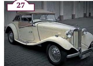
Vom MG TD „Mark II“ wurden 1711 Exemplare parallel zum normalen TD von 1949 bis 1953 hergestellt. Der „Mark II“ war die Sport-Version mit stärkerem Motor, durch große Ventile, 2 1 1/2“ SU-Vergaser, höherer Verdichtung. Zur besseren Kraftstoffversorgung versorgten 2 Benzinpumpen die Vergaser. Das Fahrwerk wurde mit zusätzlichen Andrex-Dämpfern ausgestattet. Dies sorgte für eine wesentlich straffere Straßenlage.
