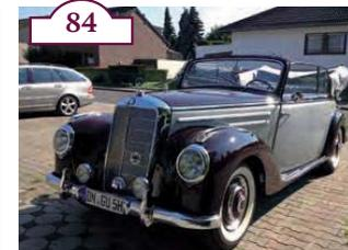
Die Konzeption des vorgestellten Fahrzeugs beruht auf einem X-Doppelovalrohr-Chassis mit holzfreier Ganzstahlkarosserie und ist eine Weiterentwicklung des MB 170 mit dem Mercedes-Benz 1949 die Pkw Produktion nach dem Krieg wieder aufnahm. Erstmals kam hier ein moderner Sechszylinder-ohc-Reihenmotor mit hängenden Ventilen und 80 PS zum Einsatz mit dem der Wagen in 21 sec von 0 auf 100km/h beschleunigte und eine Höchstgeschwindigkeit von 140 km/h erreichte.
