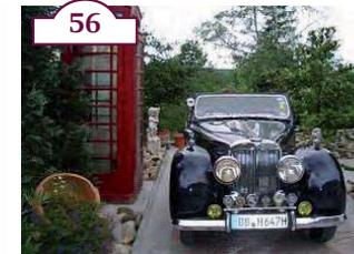
Das Modell wurde bereits vor dem Krieg konzipiert, aber erst ab 1946 wegen Materialmangel handgefertigt produziert. Die Karosserie besteht aus dem Aluminium abgeschossener deutscher und englischer Flugzeuge aus dem 2. Weltkrieg. Es wurden insgesamt ca. 1500 Fahrzeuge als 1800 ccm bis 1948 und bis Anfang 1950 als 2000 ccm Fahrzeug gebaut.
