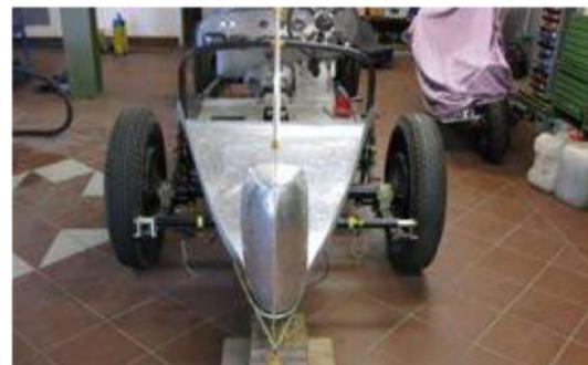
Der Karosseriebau aus Aluminium startet – in Handarbeit
