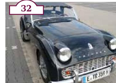
Der erste TR 3A wurde ab 1957 gebaut. Wichtige Änderung: neuer breiter Kühlergrill, abschließbare äußere Türgriffe, vordere neue Stoßstange und abschließbarer Kofferraumgriff, Overdrive-Getriebe. Der TR 3A wurde in seiner Produktion 1962 eingestellt.
